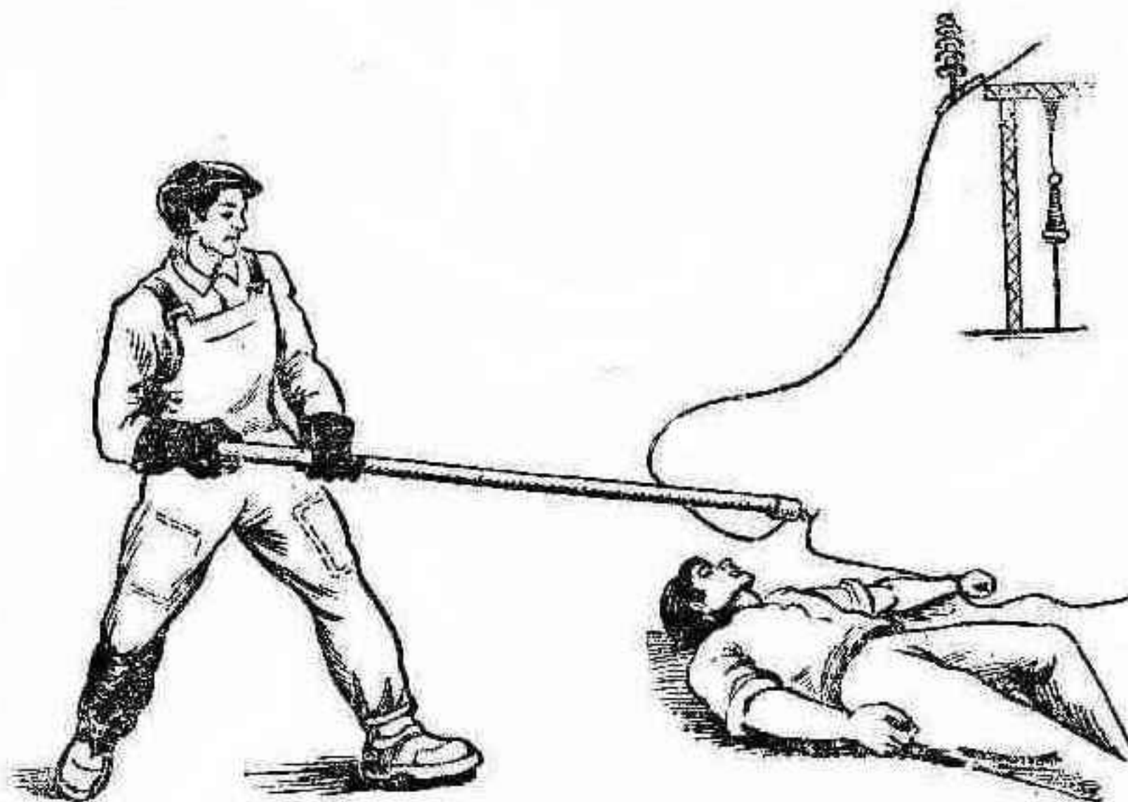
Рис. 6. Освобождение пострадавшего от тока в установках свыше 1000 В отбрасыванием провода изолирующей штангой
